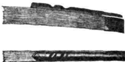
Рис 47. Вид прицела арбалета сбоку и сверху.
