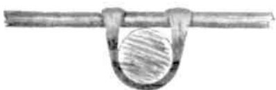
Рис 131. Деревянная деталь со сформированными на ней петлями Вид сбоку и сверху
