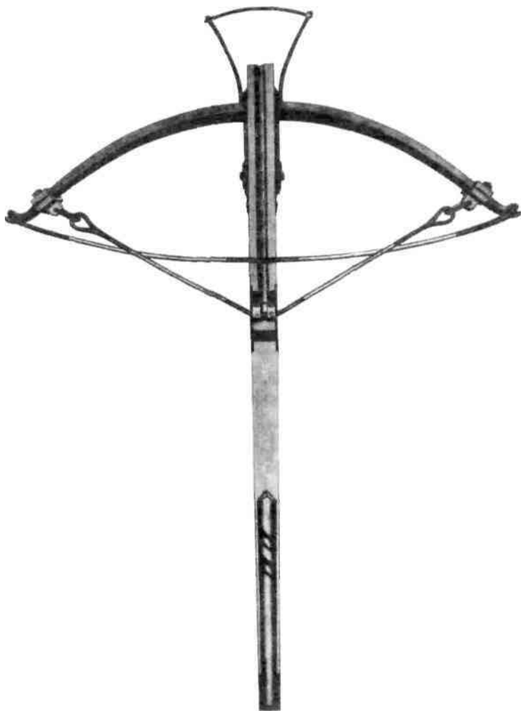
Рис. 70. Арбалет, лук которого достаточно натянут посредством вспомогательной тетивы, чтобы было можно натянуть его тетиву на зарубки на концах лука
